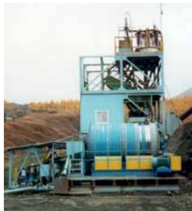
Рис. 3. Модульная фабрика на месторождении Мальдяк, Магадан
